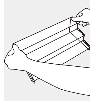
最後に階段の左右を軽く上から押さえ、パーツが抜けないか確認してください。
