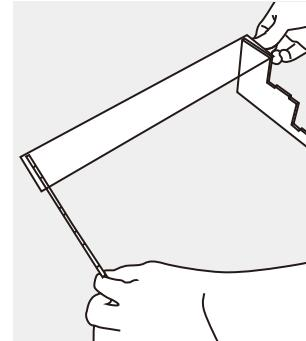
反対側にもサイドパートを立たせ、突起部分に差し込みます。1段ずつ階段パーツを取り付けていきます。
